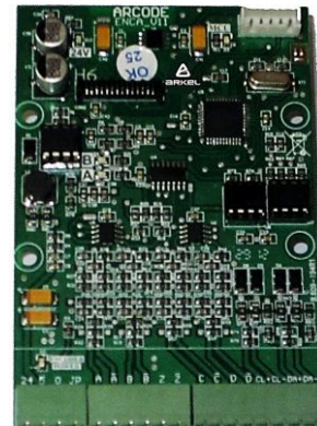
شکل ۷. ج. برد انکودر ENCA مربوط به موتورهای گیرلس
