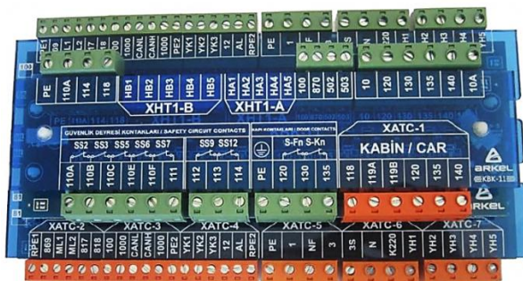
شکل ۱۱. برد KBK-10&amp;11 نصب شده در پایین تابلو فرمان
